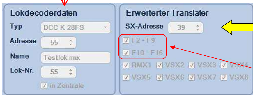
DCC-Testlok mit Translator Adresse in der RMX-LokDB
