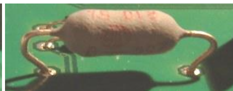
R16 - erhöht einlöten/positionieren
